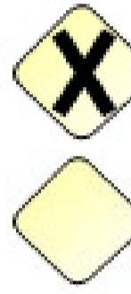
Prozessdaten werden geprüft und entscheiden über den weiteren Prozessweg.
